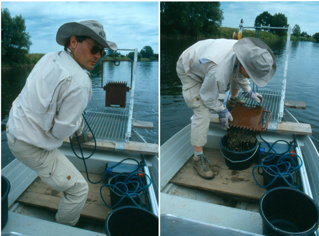
**Abb. 4.7:** Sohlprobennahme über den Bug des Bootes: Heben und Bergen des gefüllten Schürfgefäßes mit Hilfe des Auslegerarms und der Plattform (links), anschließend Umfüllen der Sohlprobe (rechts) (Photos: Ingo Sahling)
