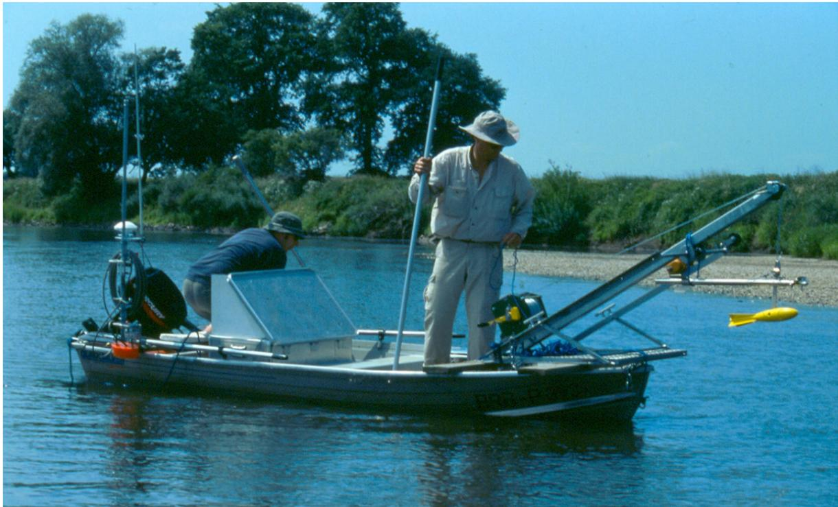
**Abb. 4.2:** Das Messboot kurz vor dem Einsatz: Über dem Bug die Plattform und der ausgeklappte Auslegerarm für die Sohlprobenahme, hier mit einem Schwimmflügel (Belastungsgewicht gelb), über dem Heck die linsenförmige GPS-Antenne (weiß), daneben die stabförmige Funkantenne (weiß), darunter der Schwinger des Echolots (orange). Die große Aluminiumkiste beherbergt die Steuer- und Rechenelektronik. (Details im Text)
