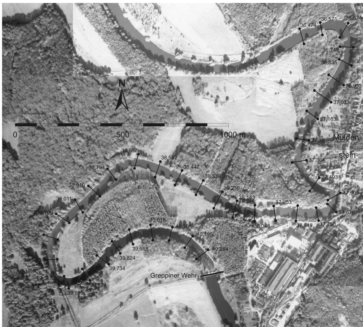
**Abb. 3.10:** Übersicht über den Untersuchungsabschnitt an der unteren Mulde mit der Lage der ausgewerteten geodätischen Querprofile (Luftbildmosaik nach THIELE 2000)
