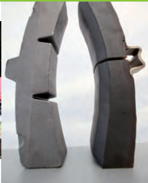
▲ Links: herkömmlicher Graugussbremsklotz – rechts: moderne Variante aus Kunststoff
